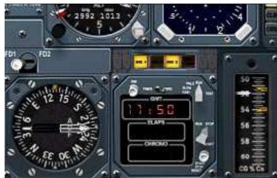
Voyants d'alerte INS sur le tableau de bord principal
